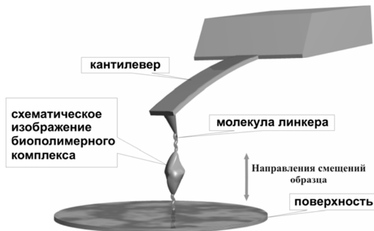
Рис. 1.3. Схема работы АСМ в режиме силовой спектроскопии.
