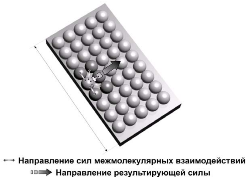
Рис. 2. Модель кубической упаковки монослоя белка на поверхности кантилевера. Стрелками указаны направления действия сил межмолекулярных взаимодействий и результирующей силы, дающей вклад в поверхностное натяжение белковой пленки.
